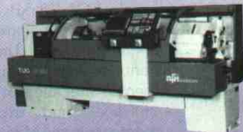
Zyklengesteuerte Drehmaschine AFM TUG 40 MN mit Siemens-Steuerung SINUMERIK 810D MANUAL TURN Spitzenhöhe 234 mm, Spitzenweite 1000/1500 mm, Drehzahlbereich 25 – 2250 U/min, Hauptantrieb S1-7 kW, S2-9,3 kW (in 30 min)
