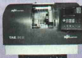
Schrägbett Produktions CNC-Drehmaschine AFM TAE 30 N mit Siemens-Steuerung SINUMERIK 810D/840D 12-fach VDI 30 Werkzeugrevolver mit und ohne angetriebenen Werkzeugen Fabrikat SAUTER, C-Achse, Gegenspindel mit 7,5 kW Antriebsleistung, Spindelbohrung 55 mm, Drehzahlbereich 50 – 5000 U/min
